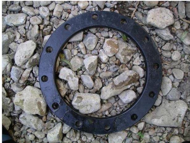
Abbildung 11 Sohlsubstrat mit dominantem Substrat „kleine Steine (6 bis 12 cm) und subdominantem Substrat „Grobkies“ (2 bis 6 cm), die mittlere Korngröße  $d_m$  liegt unter 6 cm
