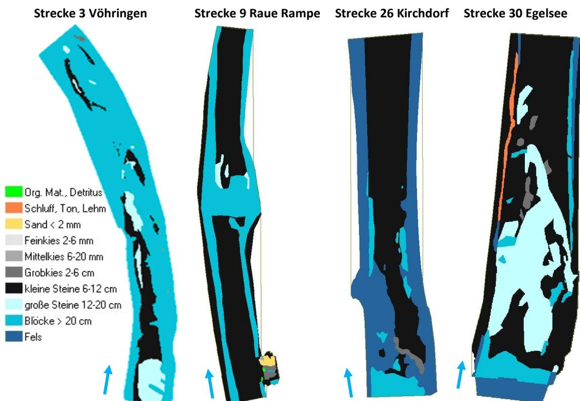
Abbildung 12: Kartierte Sohlsubstrate in den vier Detailstrecken
