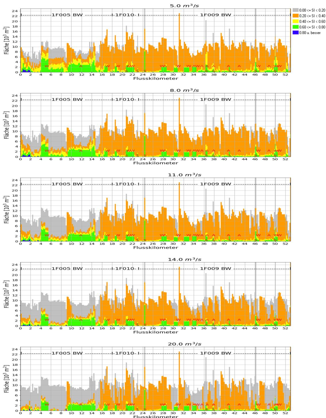
Abbildung 139 Flach abfallende, angeströmte Hänge bei unterschiedlichen Gesamtabflüssen (Mutterbett + 2  $\text{m}^3/\text{s}$  Seitenarme) im Planzustand (Längsschnitte über die 3 Flusswasserkörper der Bearbeitungsstrecke) **blau**: sehr gute; **grün**: gute; **gelb**: nutzbare, **orange**: ungünstige, **grau**: vermiedene Habitate, **A**: Wehr-Absenkung; **W**: Aufweitung; **S**: Seitenarm (untere Anbindung)
